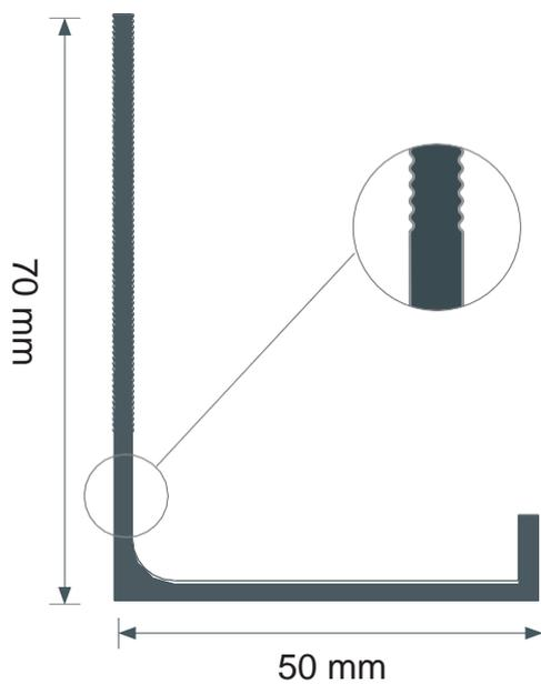
Die geriffelte Oberfläche ermöglicht ein einfaches Einführen in die Halterung.
